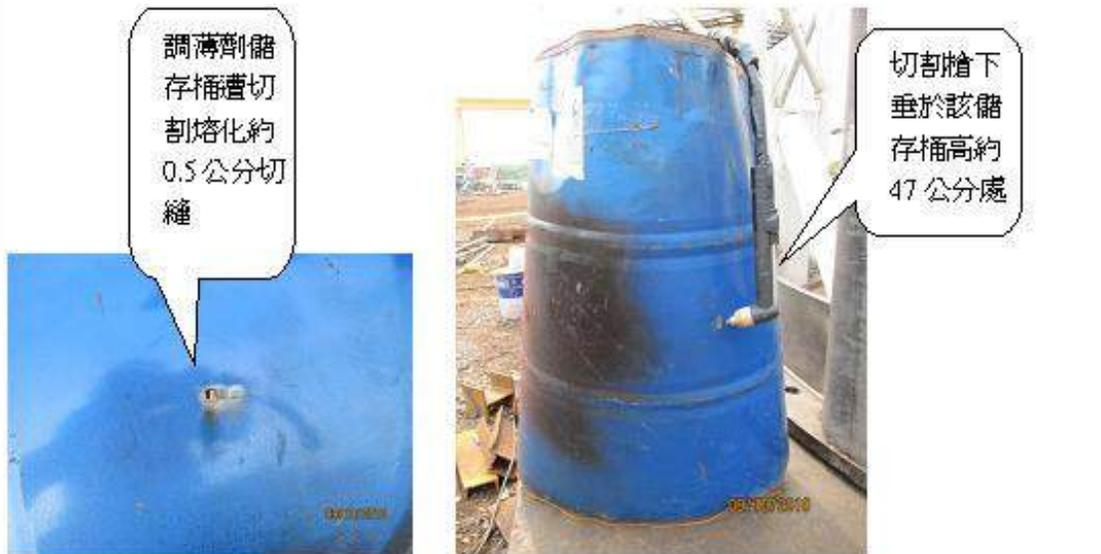
說明二 照片 2: 切割槍下垂於該儲存桶高約 47 公分處, 因切割槍晃動而碰觸切割槍上啟動鈕, 環氧樹脂調薄劑儲存桶遭切割熔化的約 0.5 公分切縫。
