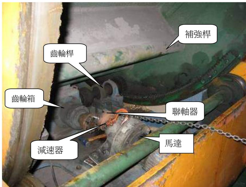
照片 2 罹災者使用鉗頭敲打聯軸器，使聯軸器與包裝平台脫離、手動鏈滑輪固定於馬達
