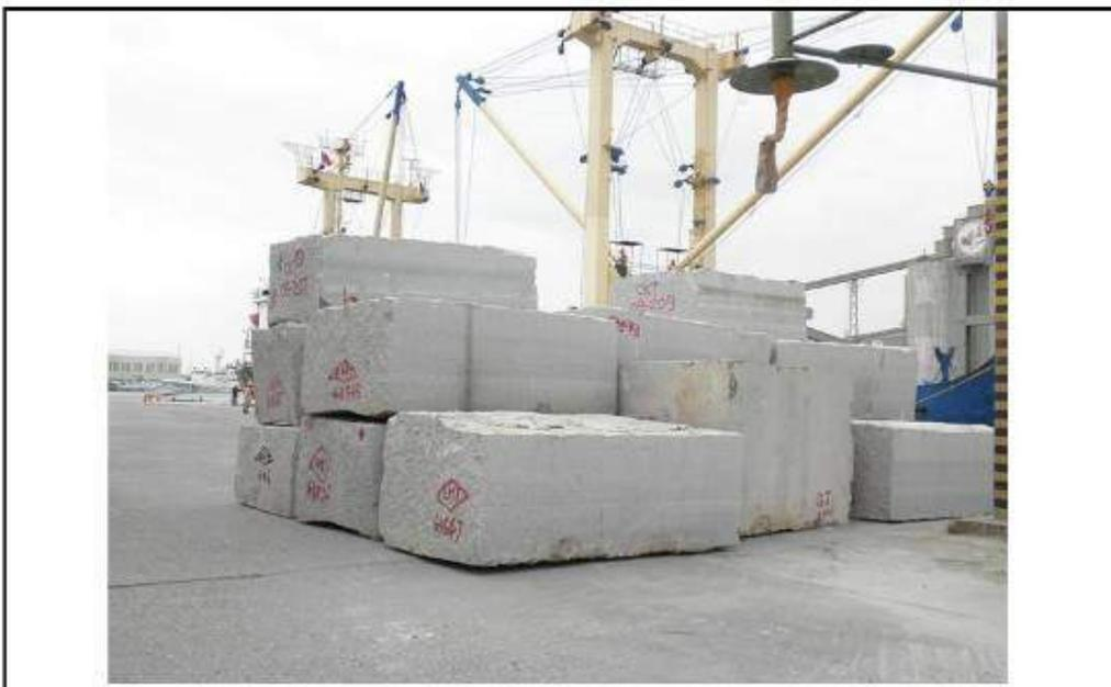
照片二：吊掛之石塊體積約1公尺×1公尺×2公尺；重量約15公噸。
