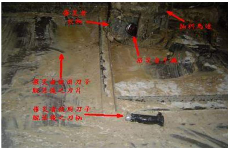
圖二 抽光攪拌槽內之飼料水，發現罹災者之衣物、使用之刀柄及刀片
