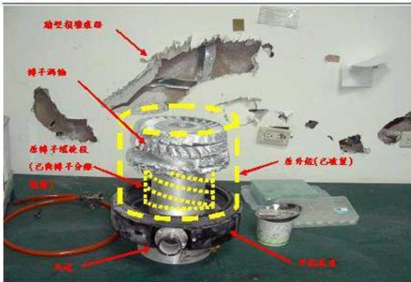
照片 筆型真空系平衡測試時位置
