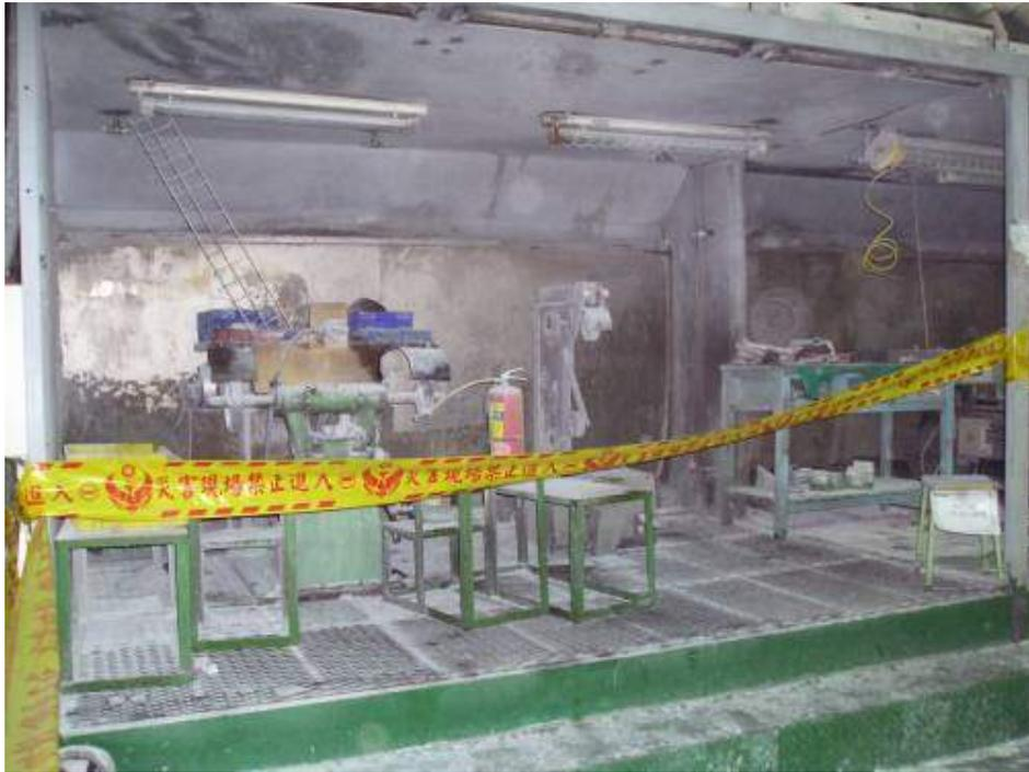
照片：鋁鎂合金腳踏車零件研磨致粉塵引起火災爆炸
