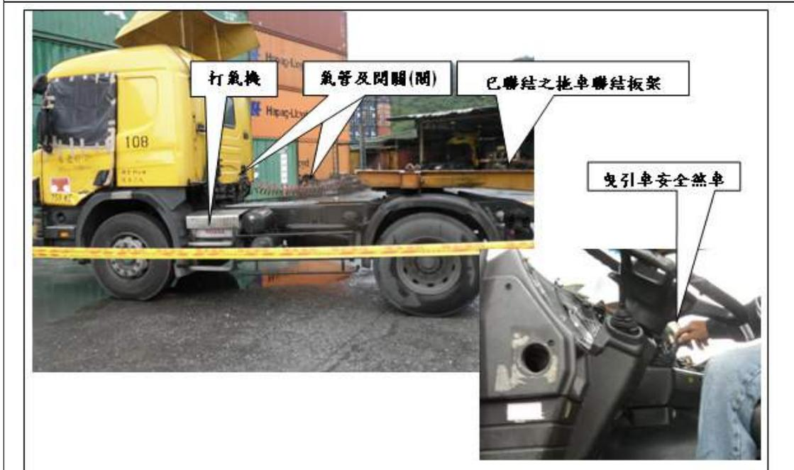
附圖二、肇災曳引車(車號:○○○-○○)相關機件及其已聯結之拖車聯結板架
