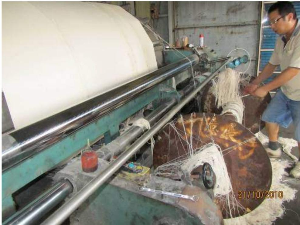
附照 2：整經機煞車橫桿置於操作位置及示範作業情形。
