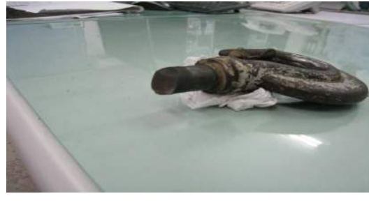
說明二 滑輪組軸心斷裂圖。
