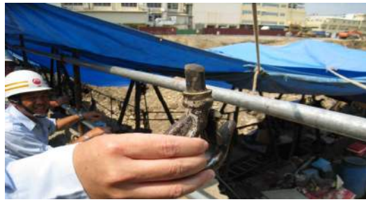
說明二 滑輪組軸心斷裂圖。
