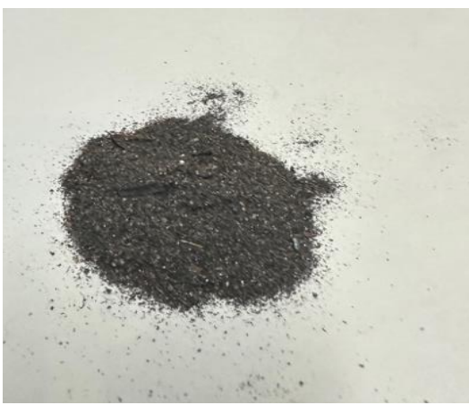
鐵粉 (集塵機) 打磨拋光作業區
