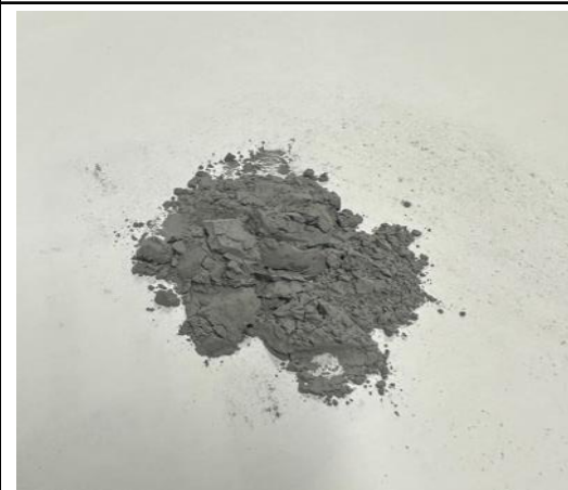
鎂鋰粒(含切削油+水) 切削作業區
