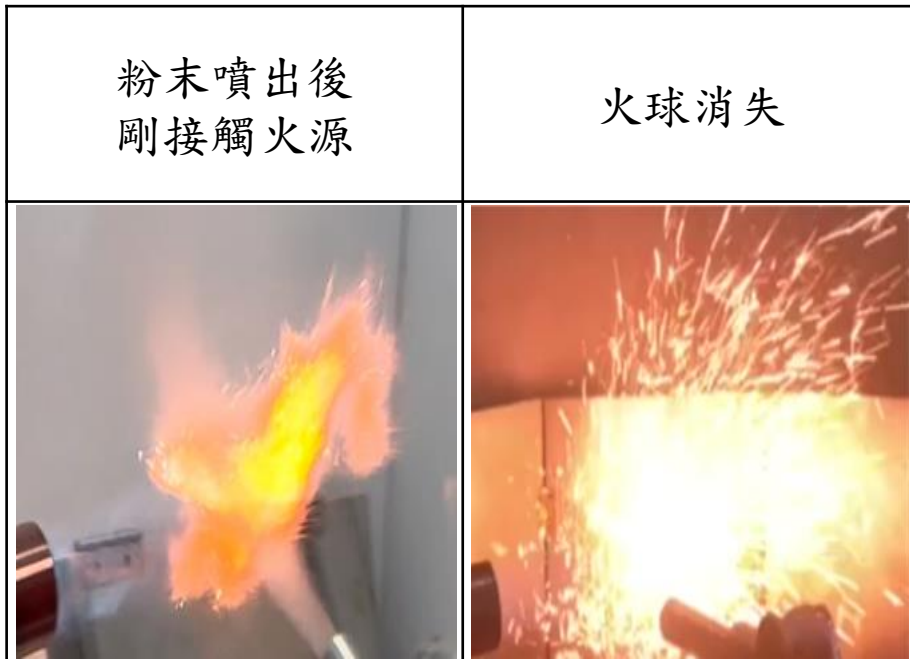
鈦合金(集塵機)粉體可爆性測試情形
