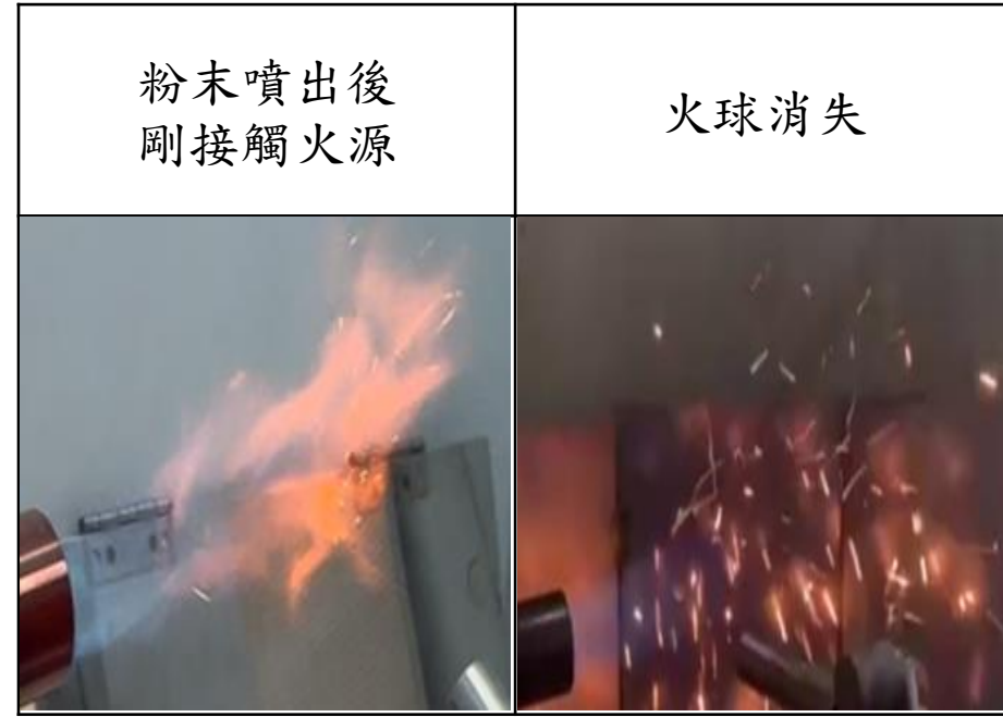
鐵粉(集塵機)粉體可爆性測試情形
