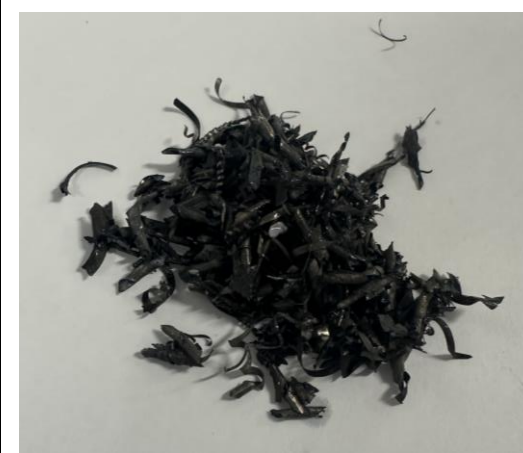
鎂鋰粒(含切削油+水) 切削作業區
