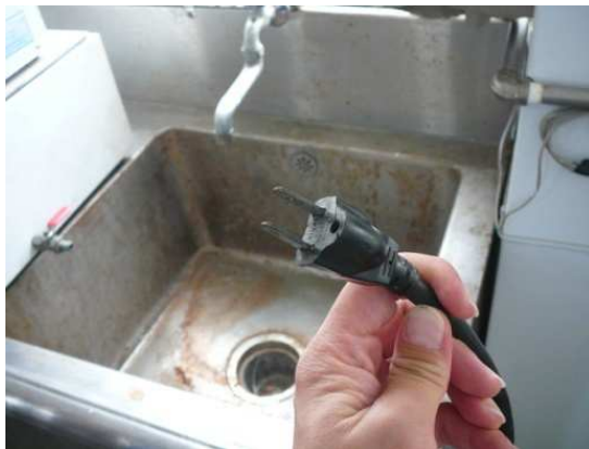
照片二 本所派員檢查當日，水 槽放在不 鋼水槽上插電，用三用電表量測水 槽及不 鋼水槽間有 66.3V 電壓差
