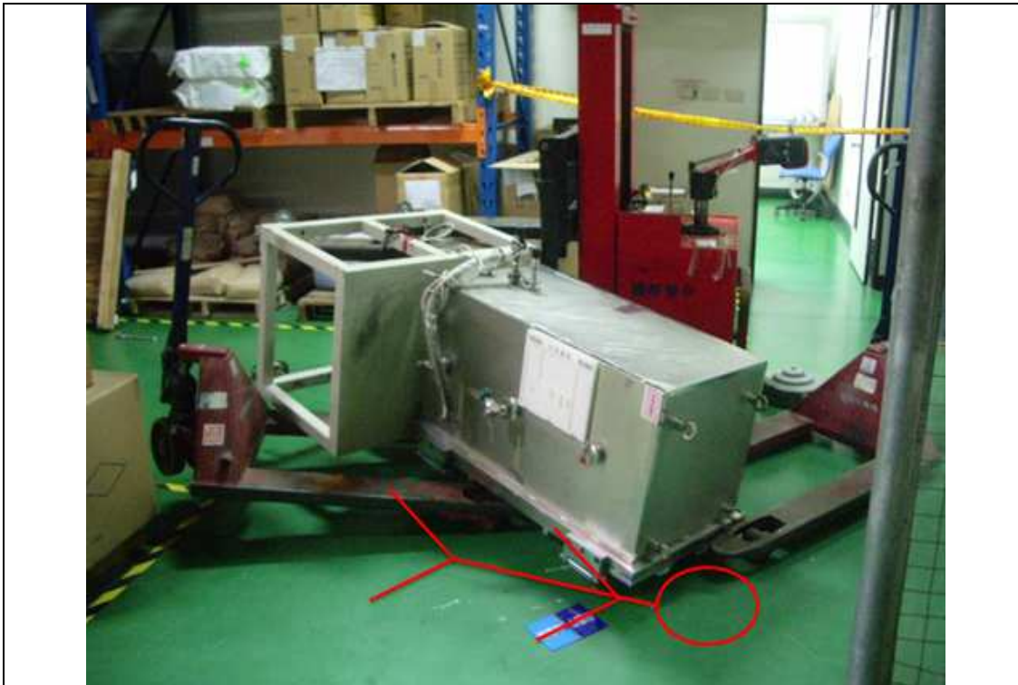
照片說明一：從事跨提型堆高機作業，發生抽真空機傾倒壓住罹災者肇災現場
