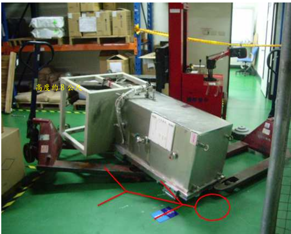
從事跨提型堆高機作業，發生抽真空機傾倒壓住罹災者肇災現場
