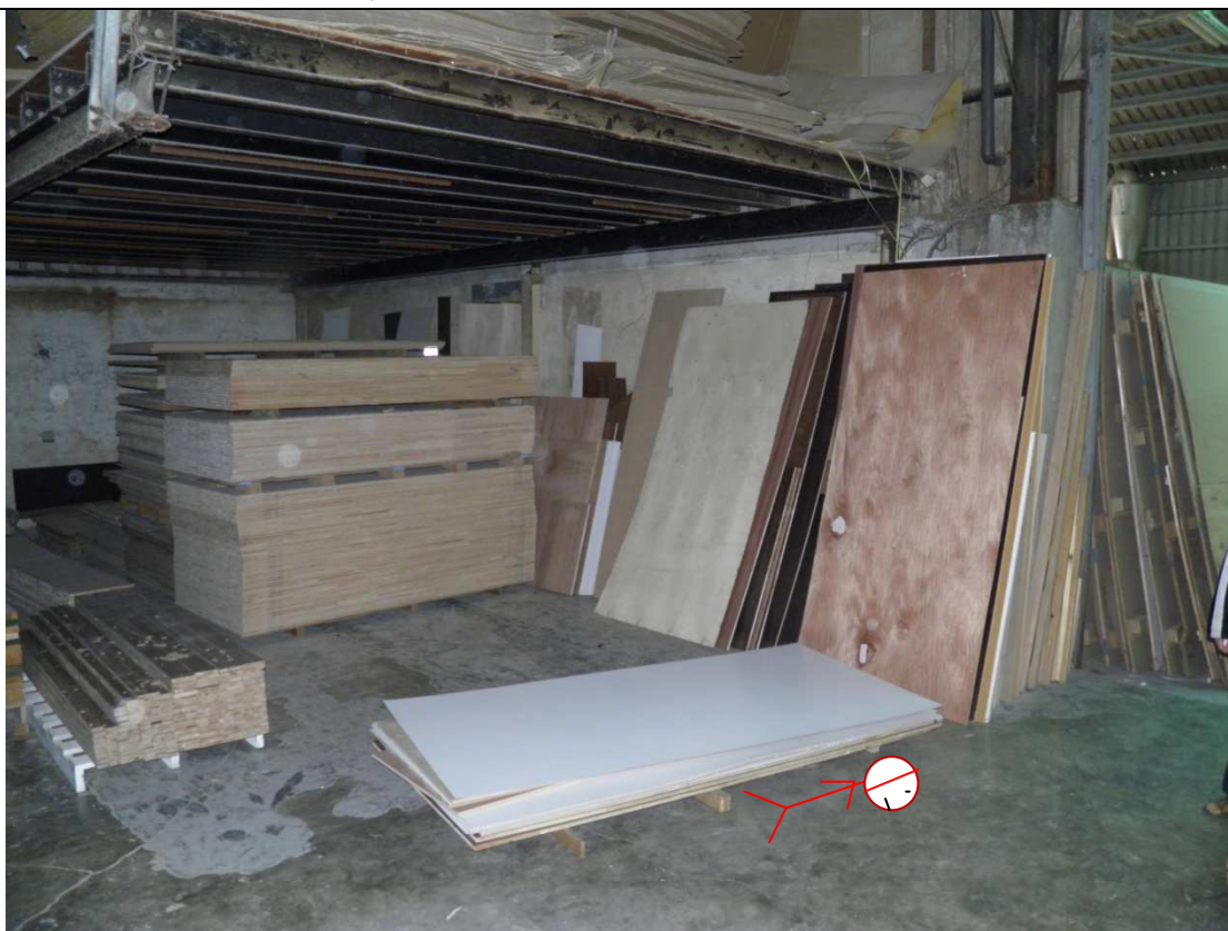
說明：災害現場倒塌木板示意圖，倒塌木板約計 14 塊，重量約 105 公斤。
