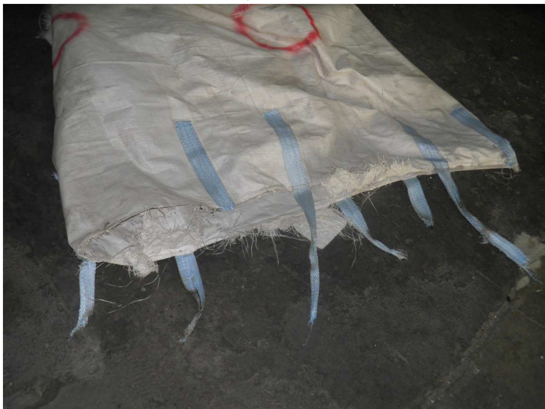
照片 2：空包裝的 4 條吊耳斷裂之情形
