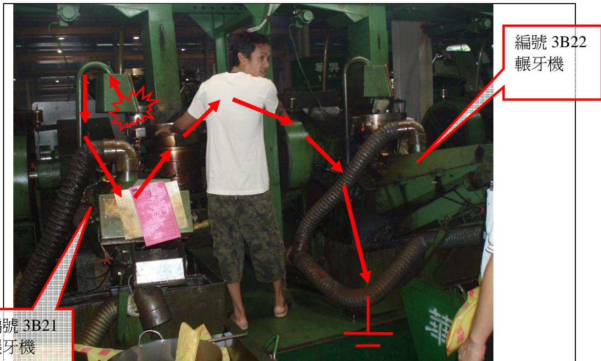
照片說明 1 研判漏電電流流經路徑為：編號 3B21 軋牙機操作面板 編號 3B21 軋牙機機 罹災者左手 罹災者身體 罹災者右手 編號 3B22 軋牙機機 3B22 軋牙機接地線。
