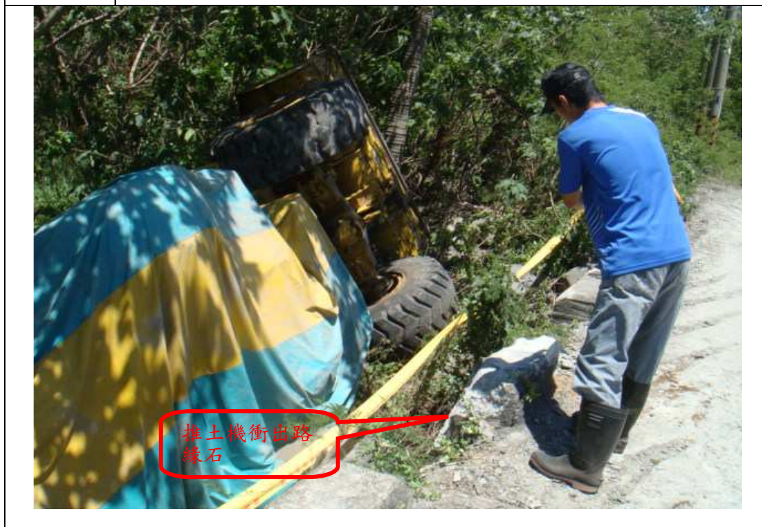
照片說明二：推土機 離車道衝出路緣石情形。
