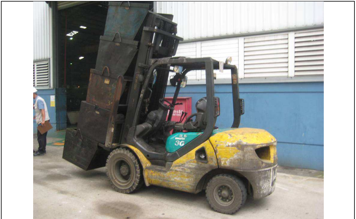
照片說明 1：肇災堆高機(荷重 3 公噸)當時運送 5 個螺絲空桶。
