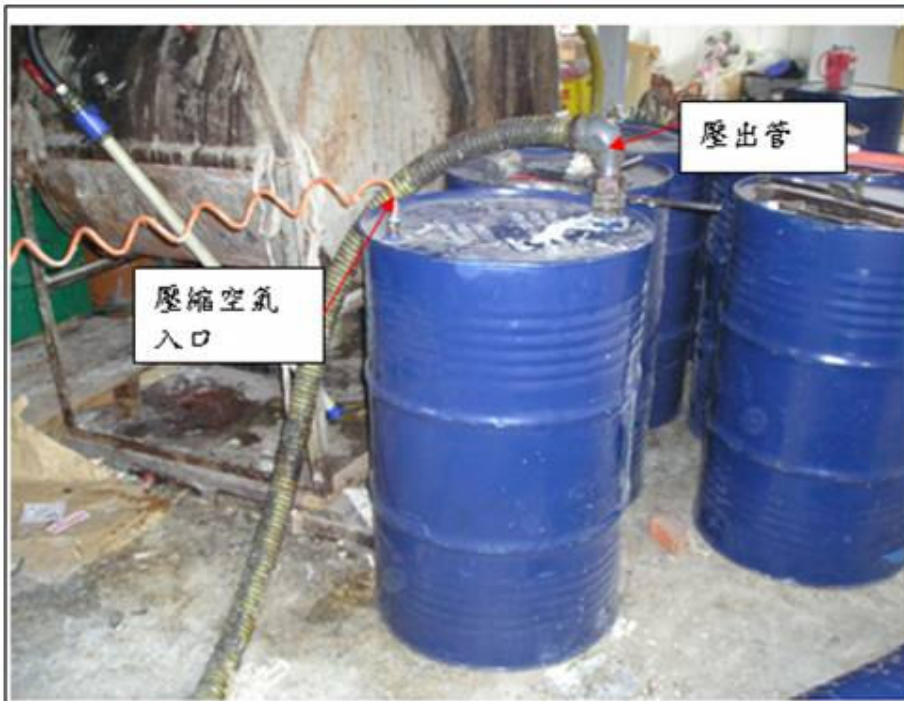
說明 裝天然橡膠液鐵桶，鐵桶直徑約 58 公分，高度約 89 公分
