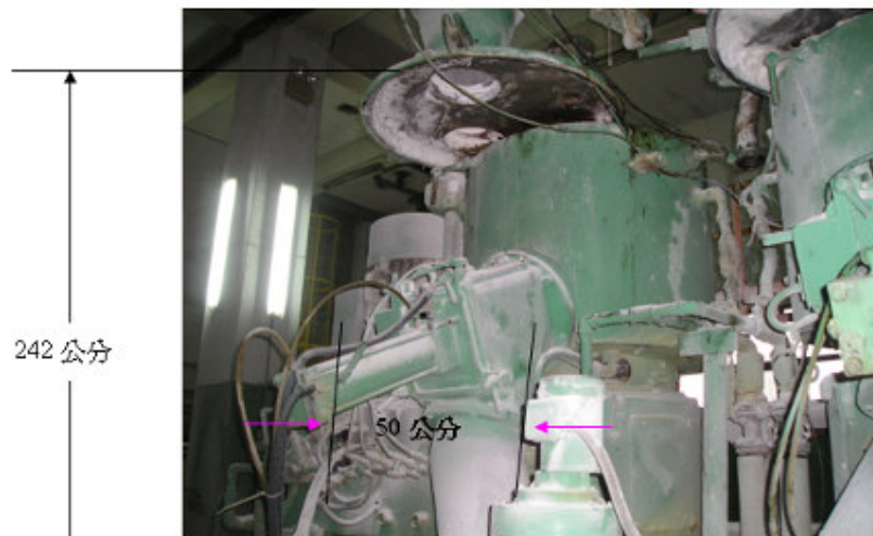
照片 1：△、□二座高速混合槽，均是直徑約為 115 公分、厚度約為 5 公分、高度約為 105 公分之鋼製槽及 1 個由 440 伏特 90/45 仟瓦、轉速為 1765/875 RPM 馬達所驅動之 3 葉片攪拌器所組成。
