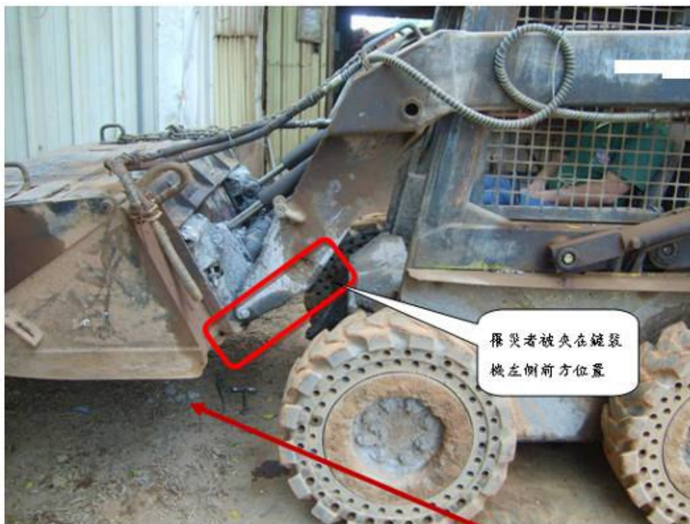
照片：發現罹災者被夾時，鏈裝機前方油壓桿已接上掃地機，地面有十字起子及鐵錘。
