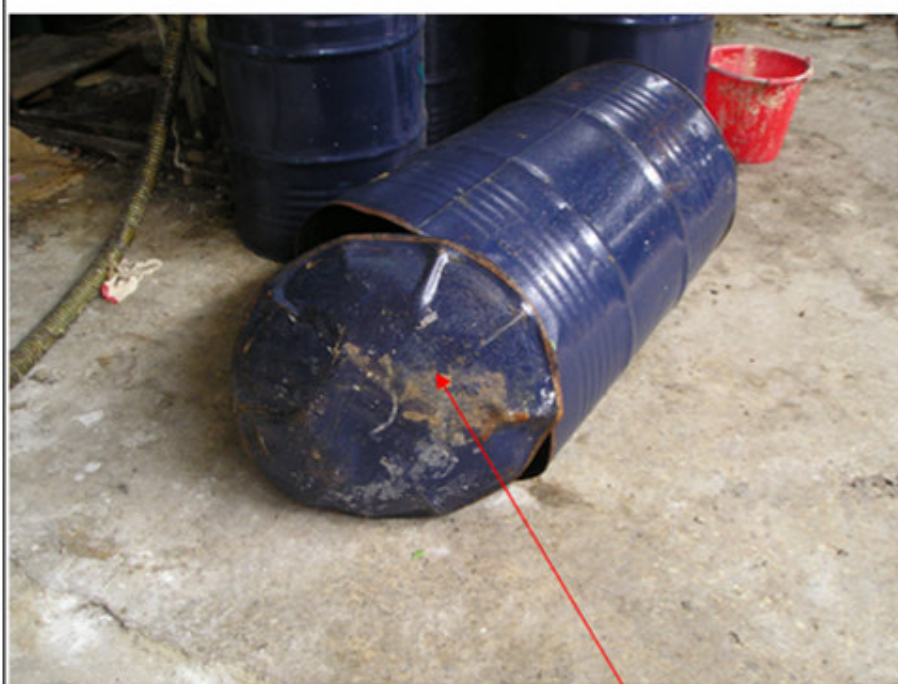
說明 鐵桶兩側端板往外凸，底部已脫落
