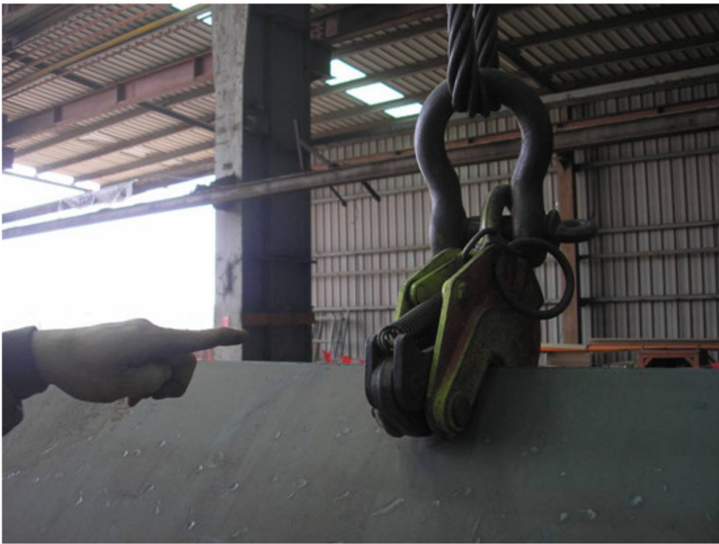
吊運 BH 型鋼板件所使用之 C 型夾
