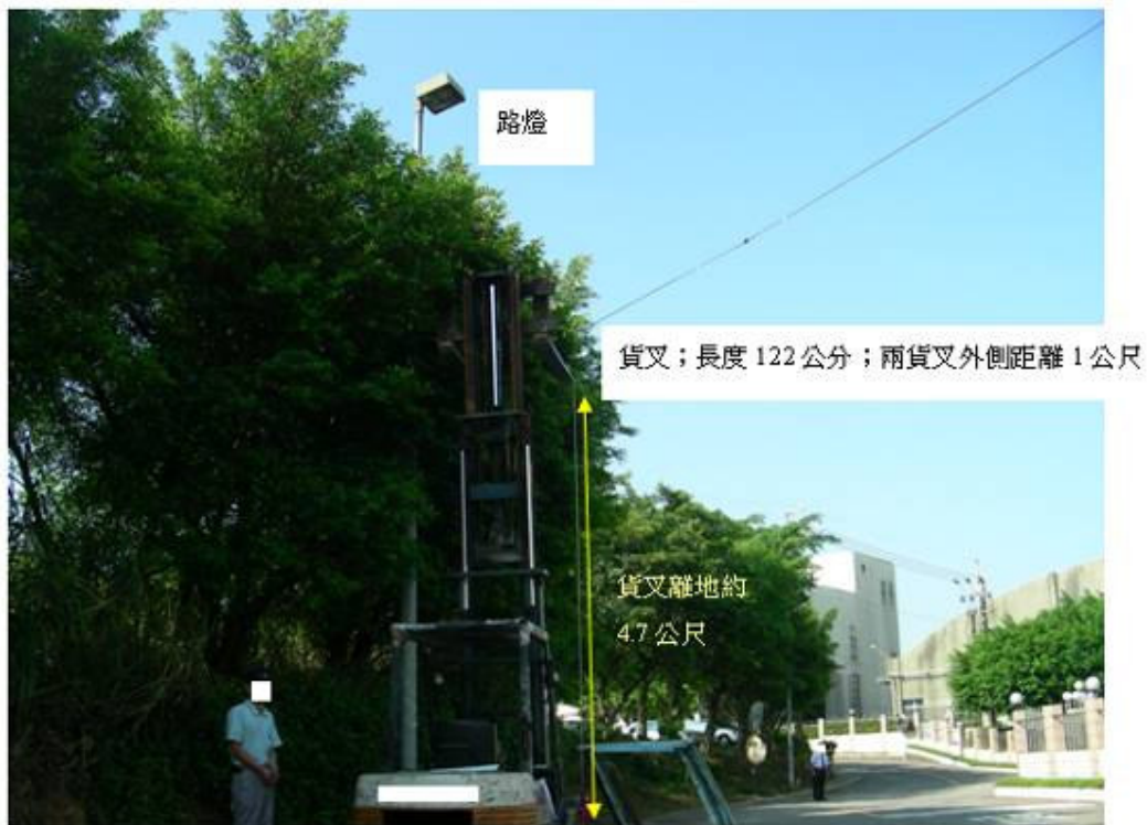
照片 2：堆高機貨叉升至約 4.7 公尺位置(模擬)。
