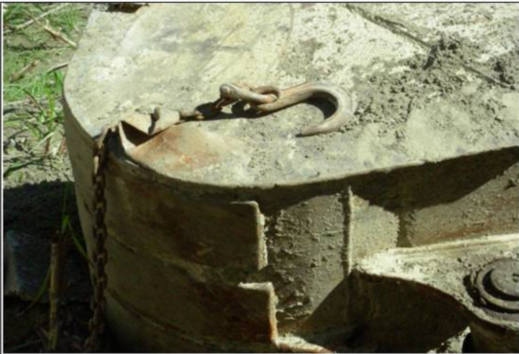
照片四 吊掛水泥塊用之鉤頭及鍊條
