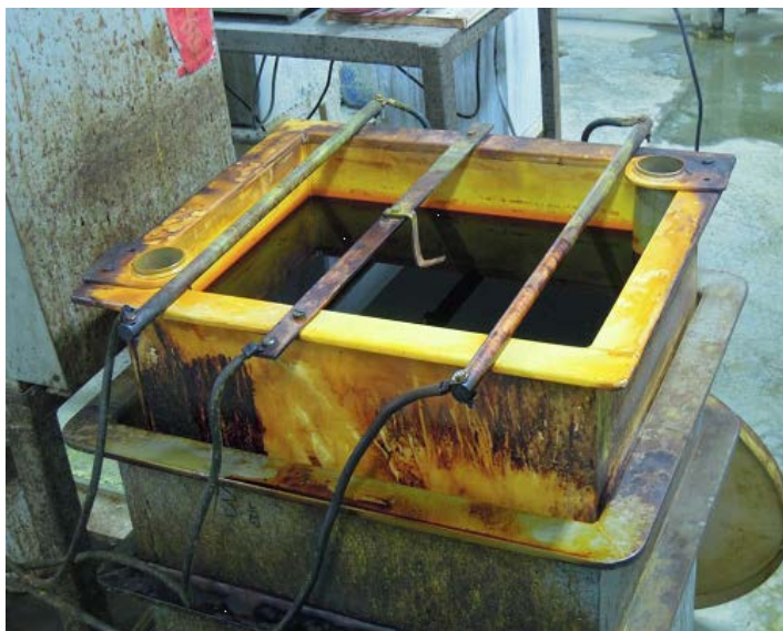
圖 1. 電鍍鉻酸槽：中央鐵條上會掛置欲鍍上鉻之模板，左右鐵條上則掛置鉻板
