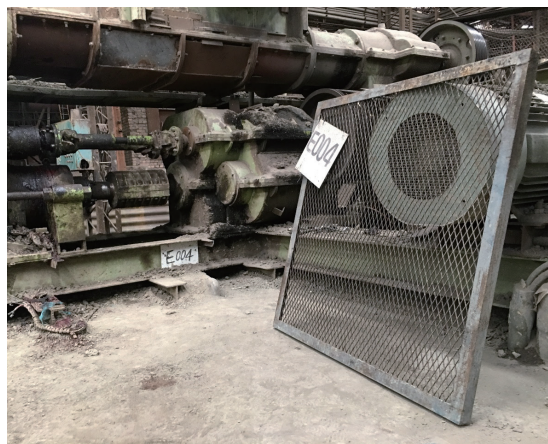
▲ 未於傳動軸有危害勞工之虞處設置護罩、護圍、套洞、跨橋等安全設備，亦未停止該機械運轉。
