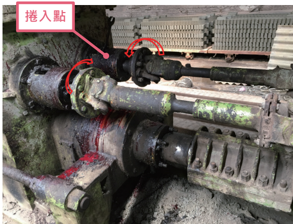
▲ 罹災者遭成型機運轉之傳動軸捲入。
