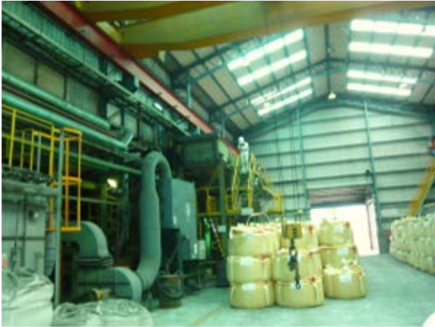
入料區：用天車吊起地上堆放的一袋袋的日本來的氧化鎳礦太空包，吊至圖中訪視人員所站立處為入料口，左下方的管路機具為較小的室內抽風機，用來抽送輸送帶上集塵罩內的粉塵。
