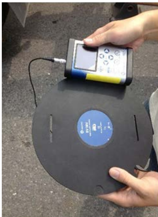
成大團隊使用 Svantek 廠商儀器進行振動量測
