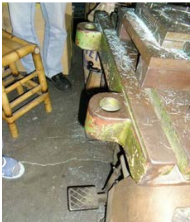
地面腳踏板開關附近亦可發現許多裁切碎屑。
