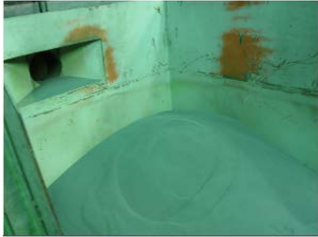
入料口，後方為集塵設備，為開放式的集塵，因此無法避免粉塵的飛揚外洩。
