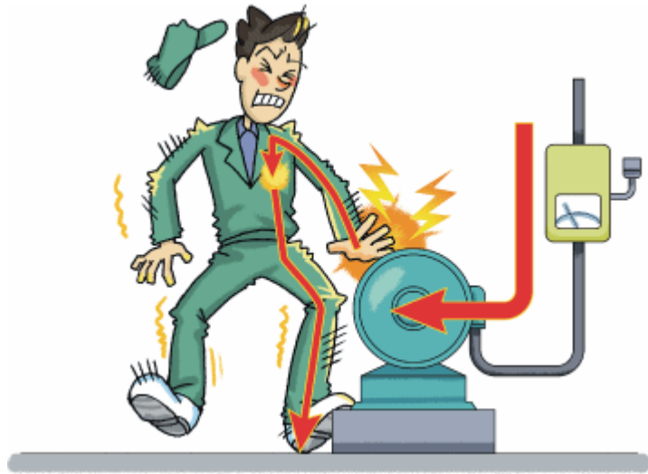
設備未接地及裝設漏電斷路器
