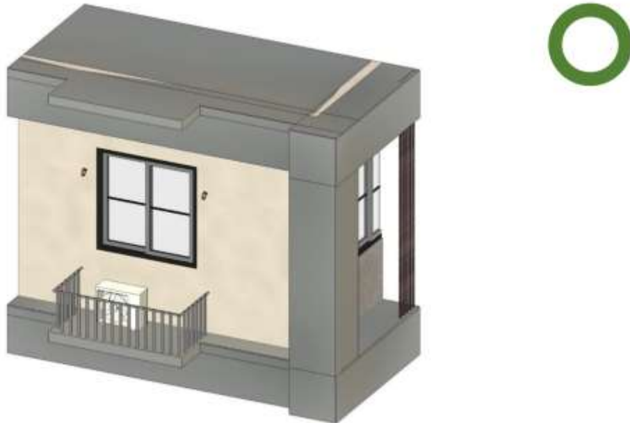
圖 2-1、雨遮設置室外機範例
