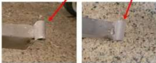
說明：經查一同掉落之鐵格柵，其鉸鏈皆完好無損，研判為勞工進行窗台鐵格柵復歸作業時，疑重心不穩，導致罹災者及鐵格柵一同從開口處墜落至地面。
