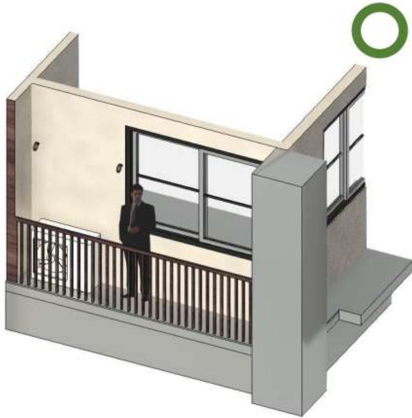
圖 2-2、露樑設置室外機範例
