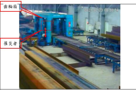
8 時 30 分 34 秒罹災者進入型鋼開槽加工機肇災齒輪箱下方, 檢查齒輪箱故障原因並彎腰撿拾掉落於齒輪箱下方之型鋼墊木
