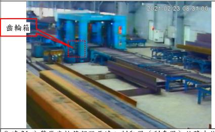
8 時 31 分肇災齒輪箱伺服馬達之制動器 (剎車器)故障未能維持常態煞車功能,致該齒輪箱瞬間又自距地面高度 150 公分處落下並壓住罹災者背部
