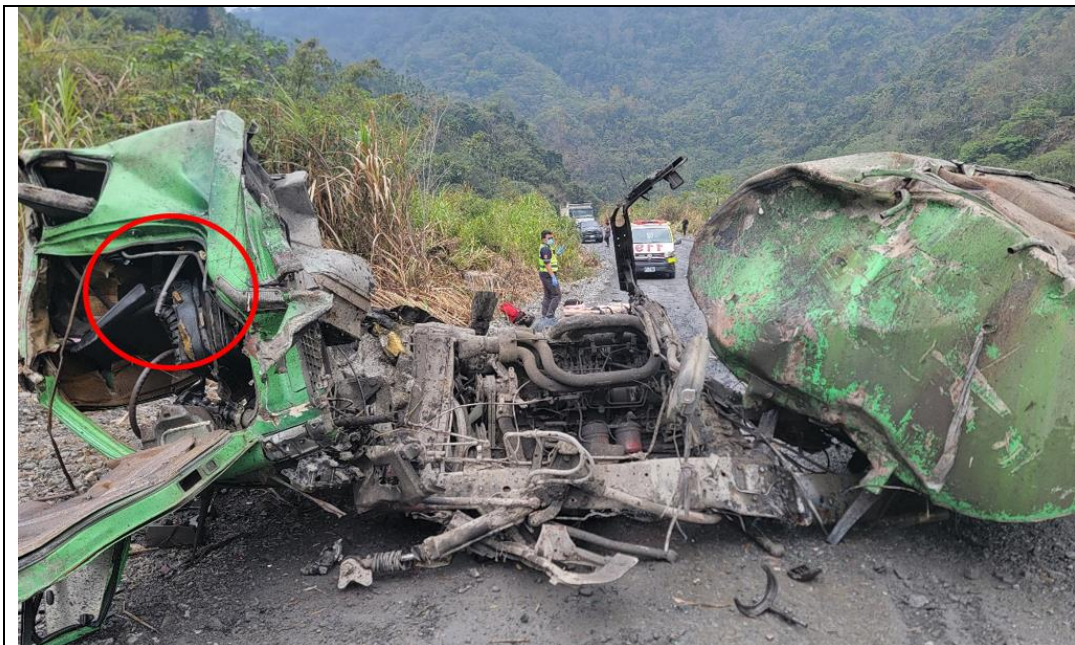
灑水車車頭全毀；現場照片發現駕駛室手煞車拉起。
